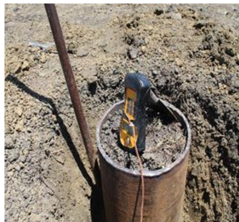
Figure 3 : La figure montre le mode de prélèvement des sols et mesure de nombre des coups des rayonnements.
