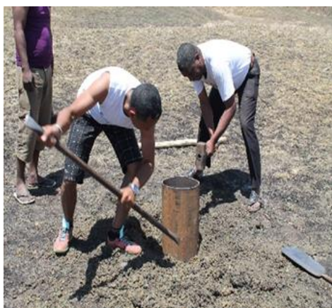
Figure 3 : La figure montre le mode de prélèvement des sols et mesure de nombre des coups des rayonnements.
