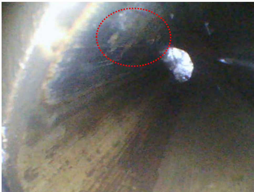
Figure 9 : Photo présentant un défaut sur le flanc de la dent de la couronne.
